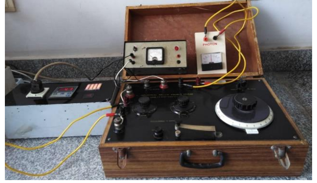
شكل (1) الدائرة الكهربائية لقنطرة كلفن المزودة
